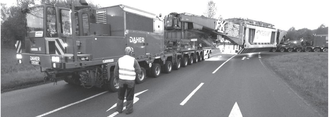
„Der 54 Meter lange Transport mit einem Gesamtgewicht von 528 Tonnen dauert insgesamt zwei Nächte. ... Zwei jeweils 12-achsige Tieflader mit insgesamt 192 Rädern haben den fast 300 Tonnen schweren und fünf Meter hohen Trafo in die Mitte genommen.“
